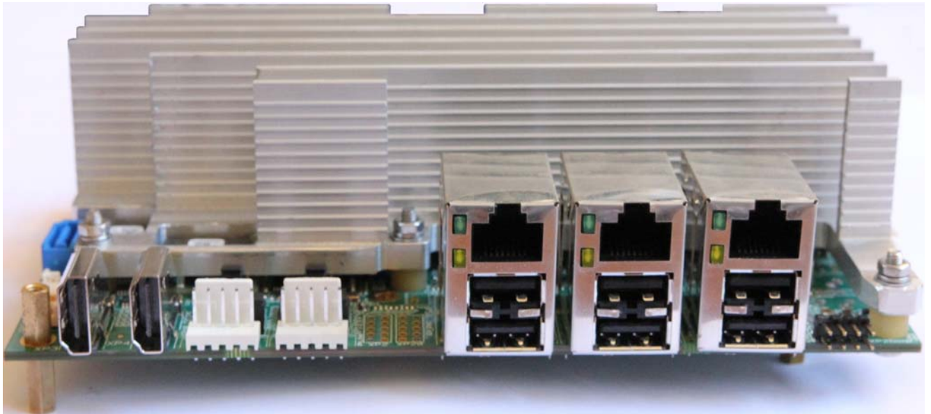
Рисунок 2.4 - Расположение интерфейсных разъемов МП16.2
