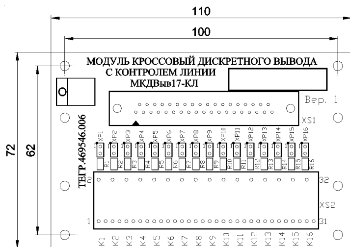
Рисунок 17 - Габаритный чертеж МКДВыв17-КЛ
