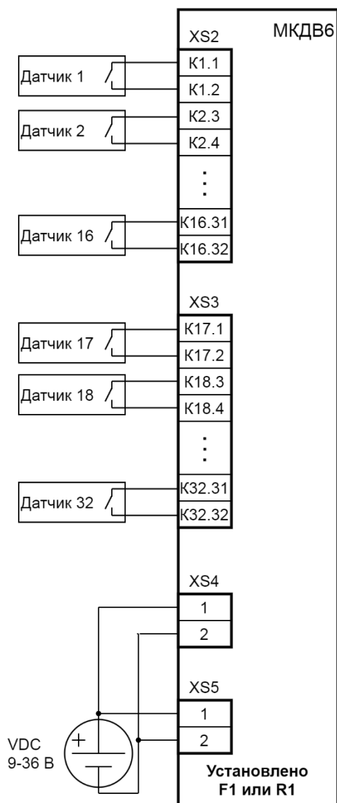
Рисунок 2.6 – Типовые схемы подключения сигналов к кроссовому модулю
