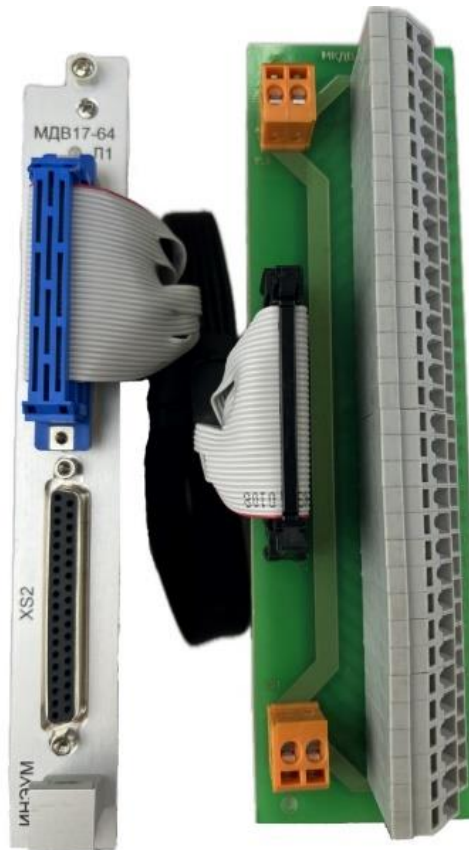
Рисунок 2.3 – Модуль кроссовый МКДВ6 и кабель кроссовый 37-37, подключенные к модулю
