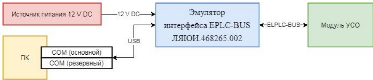
Рисунок 2.9 – Схема стенда с эмулятором интерфейса
